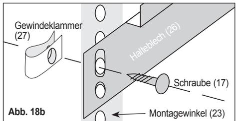
Abb. 18c: Die Halbleche werden von außen an die Montagewinkel verschraubt.
