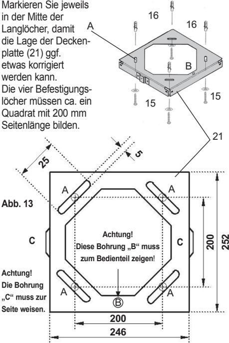
An den so markierten Stellen der Decke die Bohrungen (8 mm) vornehmen, Dübel (16) einsetzen und die Deckenplatte (21) mit vier Schrauben (15) und Unterlegscheiben befestigen. Das Befestigungsmaterial befindet sich im mitgelieferten Zubehörbeutel.
